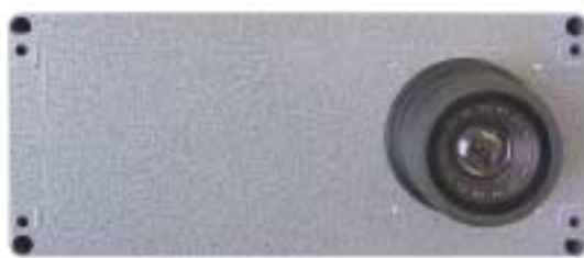
Der traversierende Farbmesskopf mit Halogen-Lichtquelle und Spektrometer
