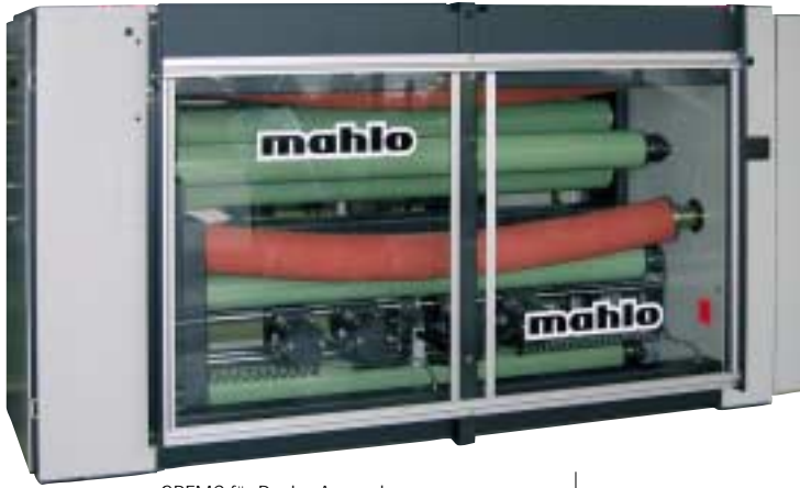
GRFMC für Denim-Anwendungen (mit teflonisierten Walzen)
