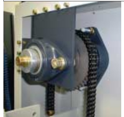
Doppel-Kettenantrieb der Bogenwalze
