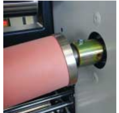
Lagerung der Bogenwalze (Antriebsseite)
