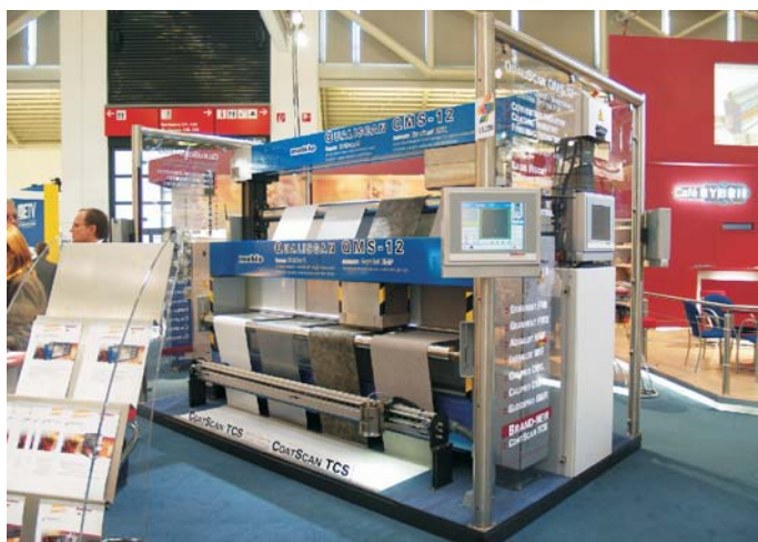
Bild 10 CoatScan TCS zur Erkennung von Rakelstreifen während der Beschichtung (Mahlo)
