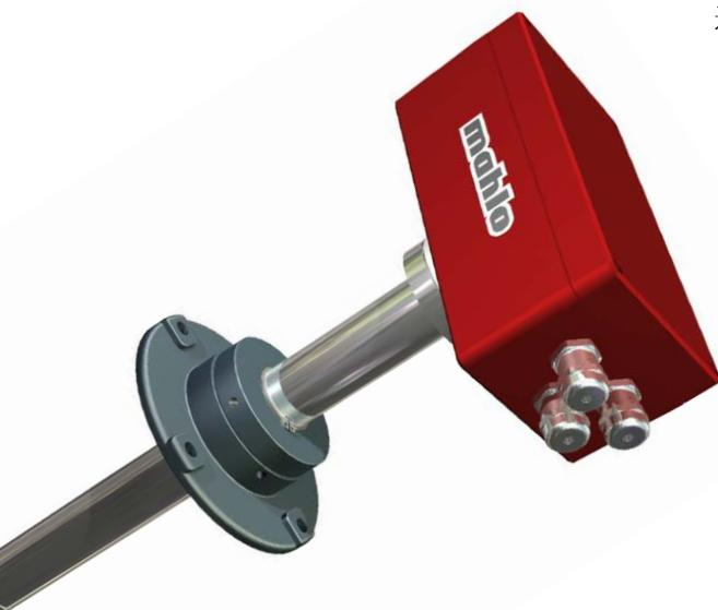
適切なコントロールがない場合、乾燥プロセスでは多量の有用なエネルギーが排気と共に失われます。エコマットAMLは排気中の水蒸気含有量を測定し、排気ファン回転数または排気ダンパーのコントロールにより熱エネルギー消費量を実際の乾燥に必要な量に調節します。
