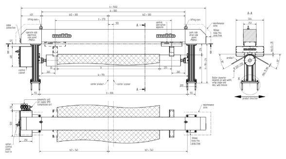
Scanning frame Uniscan S / Sensor Calipro DMS 91-018997-00
