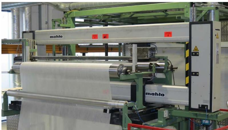
グラスファイバーと不織布によるスクリーン補強材の製造ライン
