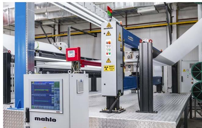
Qualiscan QMS のトラバーススキヤナが、重量、厚さまたは水分の幅方向プロファイル(CD プロファイル)と流れ方向プロファイル(Md プロファイル)を正確に測定。これらはマーロオペレーティングソフトウエアにより、タッチスクリーン画面で鮮明に表示されます。 (写真手前)
