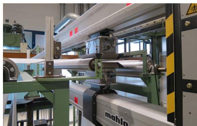
$\beta$ 線センサはアイソトープの放射線で重量を測定します。DFI 技術により、測定ギャップ通過時のウェブ上下変動には全く影響を受けません (Dynamic Flutter Independent)。最小単位の $\beta$ 線源で最高の測定機能を発揮します。
