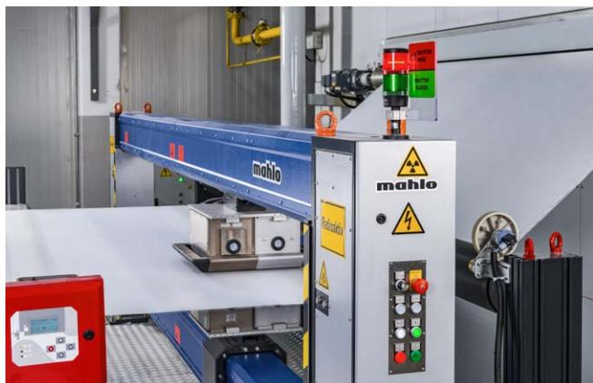
Qualiscan QMS のスキヤナ Webpro M が $\beta$ 線センサで重量を、赤外線センサで水分率を測定しています。
