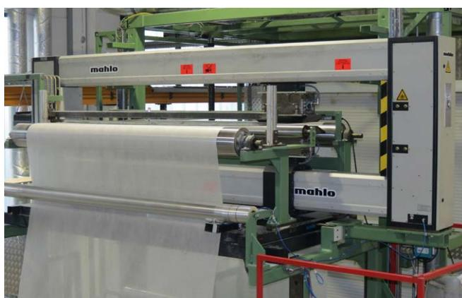
O-frame 型スキヤナ Webpro M に装着された $\beta$ 線センサ Gravimat DFI で、グラスファイバーと不織布のスクリーン補強材の重量を測定しています。
