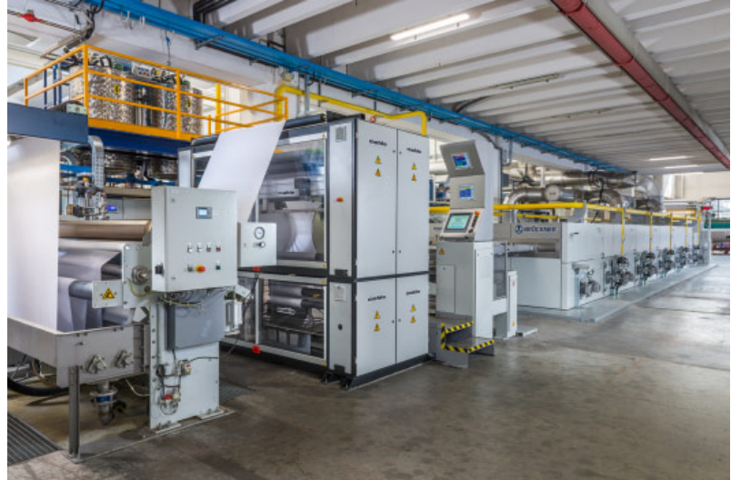
Mahlo-Kombianlage mit Orthomax RFMB und Prozesskontrolle Optipac VMC an einem Spanrahmen im Finishing-Bereich.
