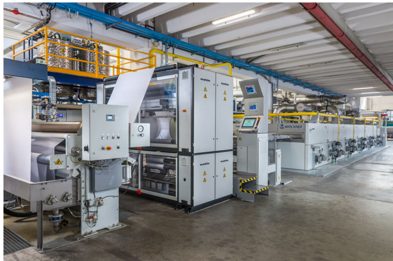
仕上げ工程のテンターでマーロ社の Orthomax RFMB と Optipac VMC (プロセスコントロール)のコンビネーションシステムを導入
