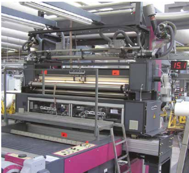
Aparelho endireitador Orthopac com dispositivo de deslocamento transversal antes da máquina de estampar rotativa
