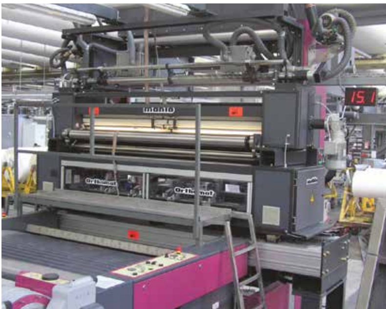
Dispositivo enderezador Orthopac con mecanismo de desplazamiento transversal antes de la máquina de impresión rotativa
