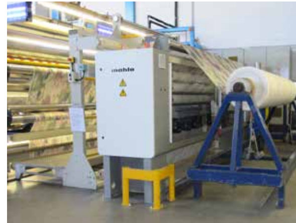
Orthopac RVMC a la entrada de un sistema de calandrado en el estampado de materiales textiles
