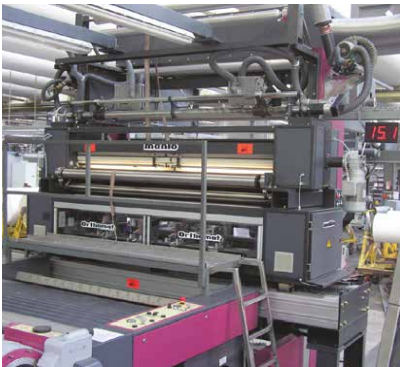
Appareil de redressement Orthopac avec dispositif de déplacement transversal en amont d'une machine d'impression rotative
