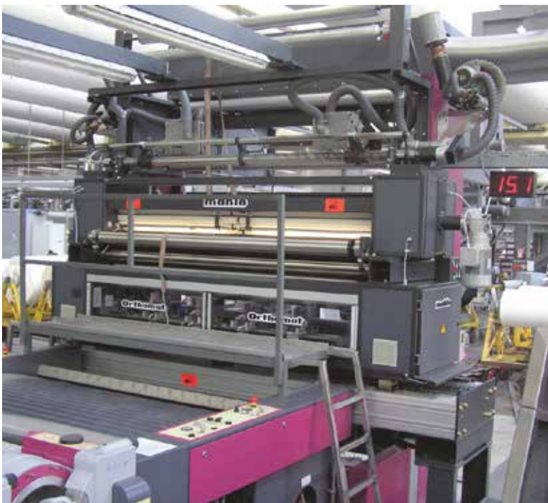
Unità di raddrizzamento Orthopac con dispositivo di spostamento trasversale davanti alla macchina di stampa rotativa
