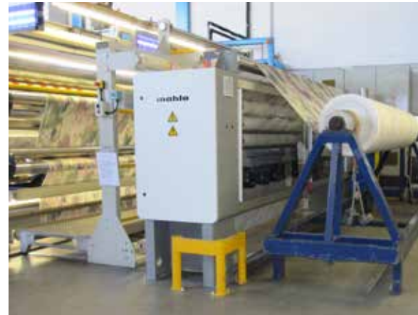
Orthopac RVMC、印刷工程のカレンダー入口に設置
