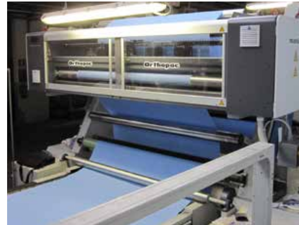
Orthopac MFRC、テンター出口に設置
