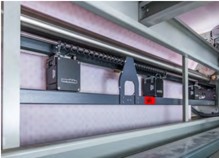
Mehrere Sensoren erfassen die gesamte Warenbreite simultan
