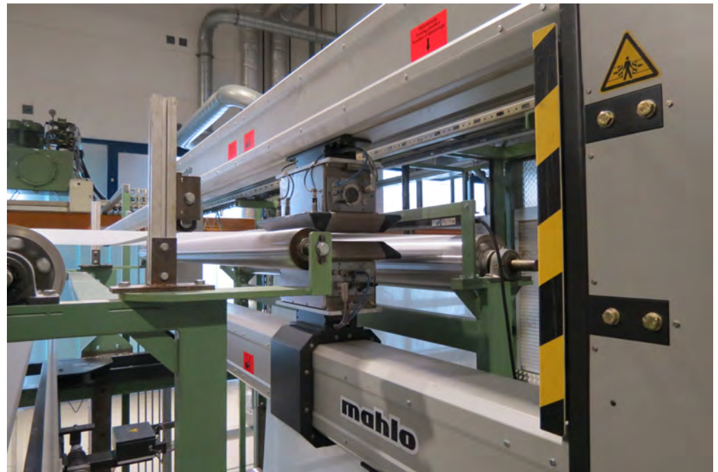
Fig. 3: Installation eines Gravimat DFI bei Kirson Industrial Reinforcements GmbH
