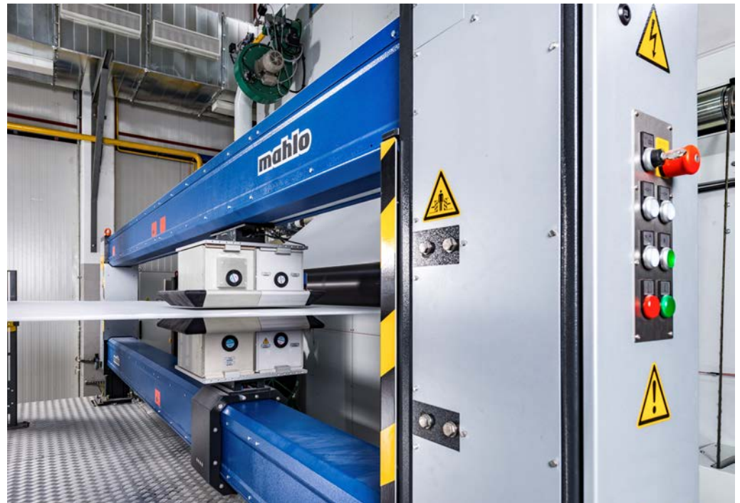
Abb. 2: Messung von Flächengewicht und Feuchte mit Infracot IMF und Beta-Sensor auf Spunlace-Nonwoven
