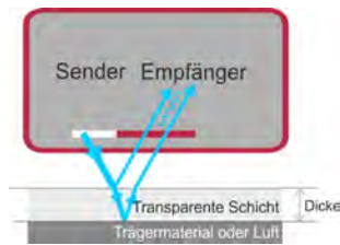
Abb. 4: Funktionsweise Optoskope WLI
