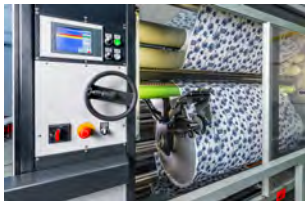
Abb. 1: Orthomax RFMB-15: Fusion aus Nadel- und Walzenrichtgerät
