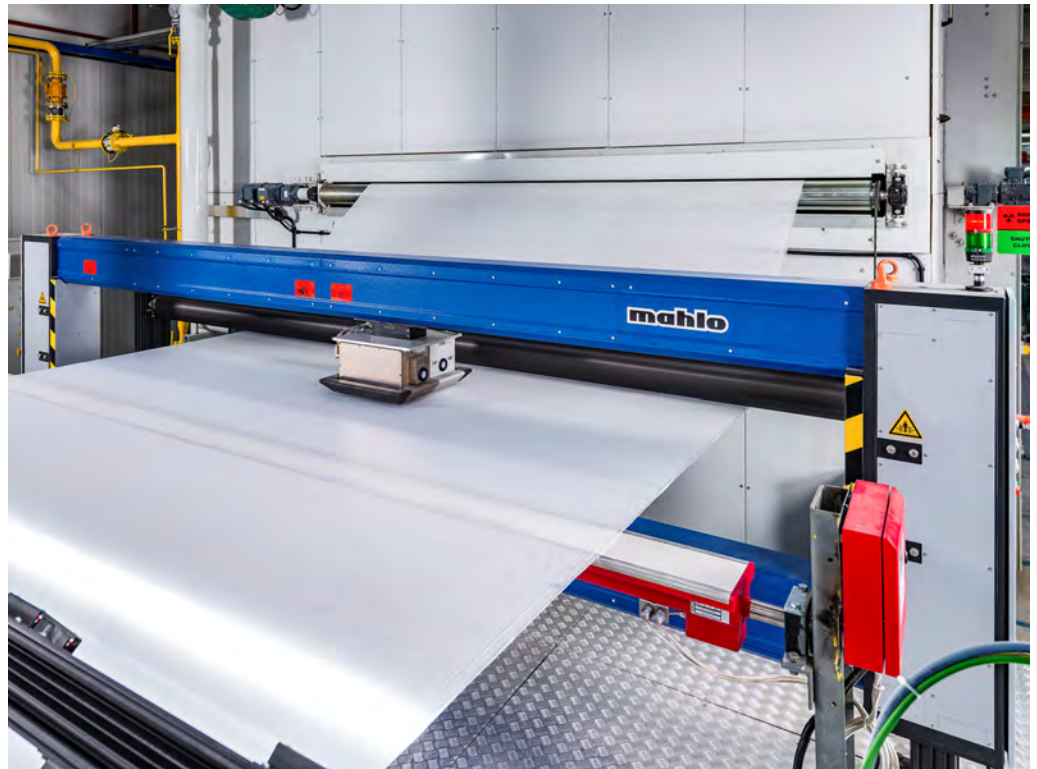
Abb. 3: Messung bei Spunlace-Nonwovens mit Infrarotsensor Infracot IMF
