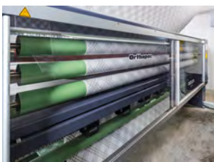
Abb. 3: Richten mit dem Mahlo Orthopac RVMC
