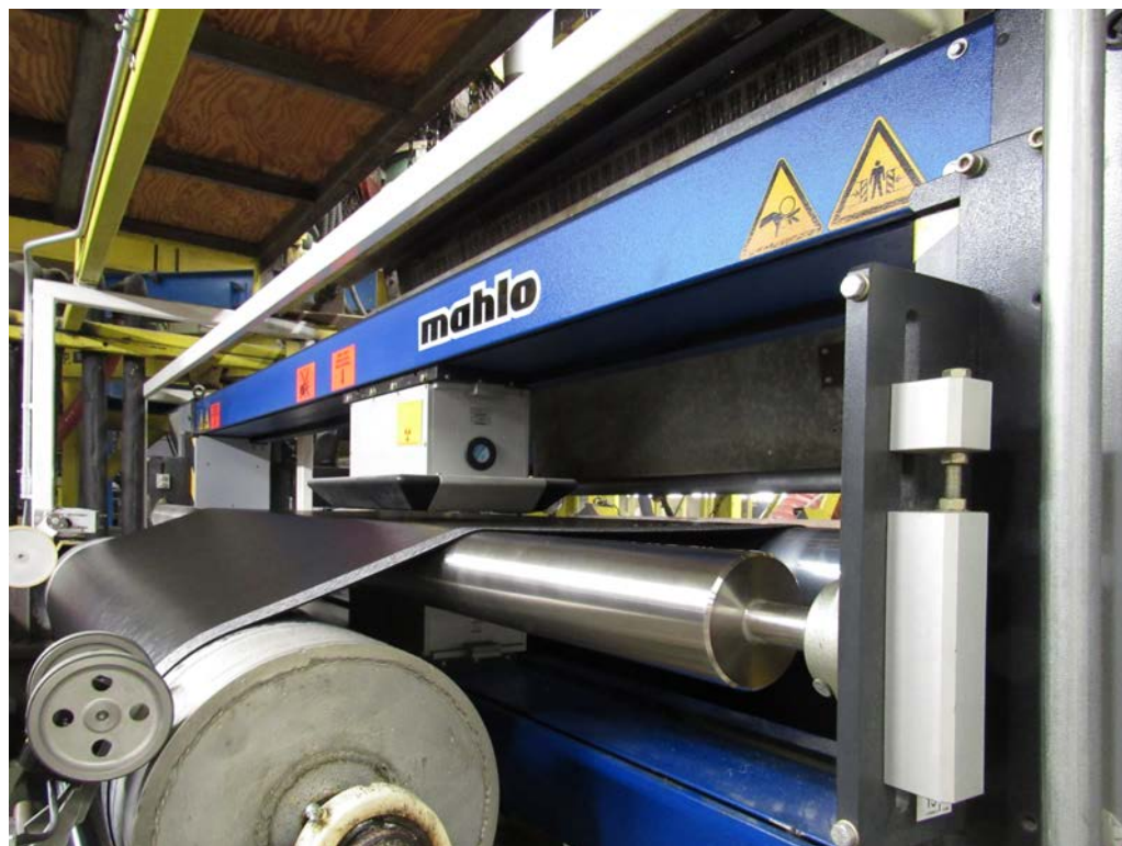
Abb. 7: Bahnmessung mit DFI-Sensor
