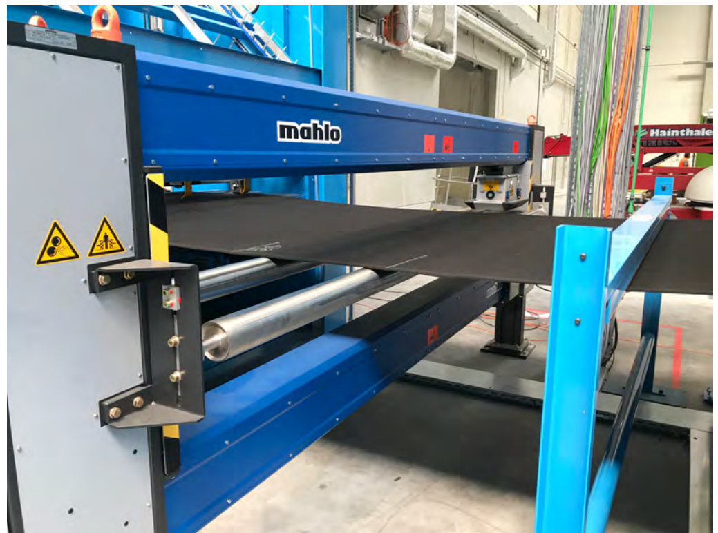
Abb. 2: Mahlo Qualiscan QMS-12 integriert in der Produktionslinie von Hanwha
