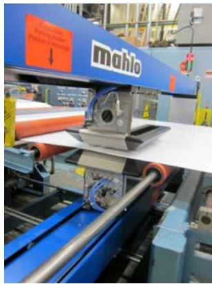
Abb. 2: Bahnmessung mit Qualiscan QMS-12
