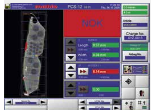
Der Scanner hat einen Fehler am Patch registriert
