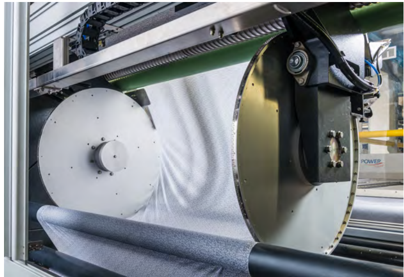
Sotto le ruote a spilli si vede il rullo stacca pezza regolabile e brevettato. Riduce al minimo le deformazioni curve e quelle nell'area delle cimose.
